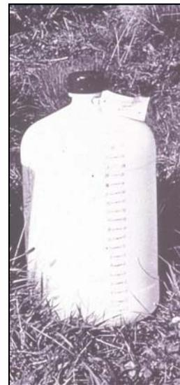
**Hueco excavado en el suelo, depósitos graduados y probeta convencional de 1 litro de capacidad**
