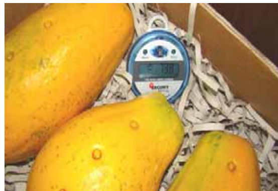
Foto 21.- Registrador de temperatura y humedad relativa en una de las cajas.
