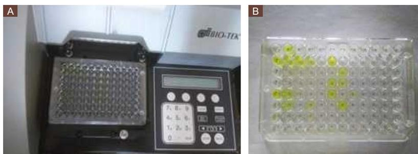
Figura 9. Detección de PLRV mediante ELISA-DAS: A, microplaca preparada para la lectura en el equipo BIO-TEX ELx800; B, microplaca con pocillos positivos coloreados.
