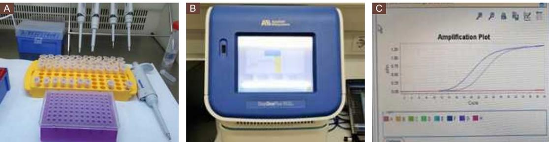
Figura 8. Procedimiento de detección de *Ca. L. solanacearum* mediante PCR en tiempo real (Teresani, 2014): A, muestras a analizar y microplacas de PCR; B, equipo de PCR en tiempo real (Applied Biosystems StepOnePlus); C, lectura de positivos en la pantalla.
