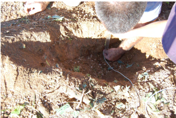
Foto 9.- Colocación del sensor de temperatura de suelo a 10 cm de profundidad.
