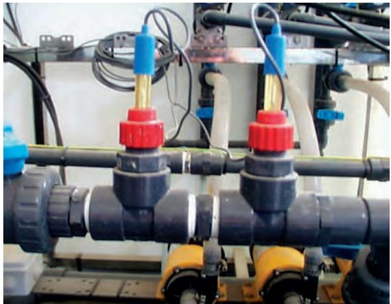
Figura 16: Cabezal con doble sonda de pH.
