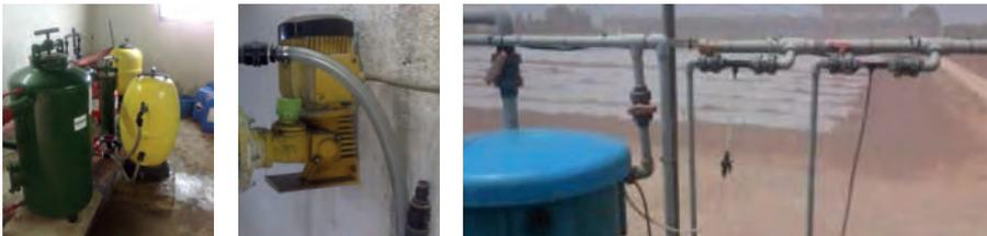
Figura 13: Sistemas de inyección con control manual:
