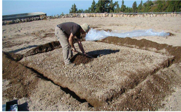
Foto 16.- Realización del hoyo para colocar sensores de temperatura a distintas profundidades.
