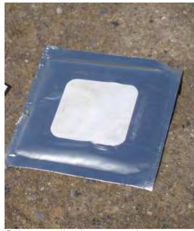
Sobre metalizado con membrana permeable.
