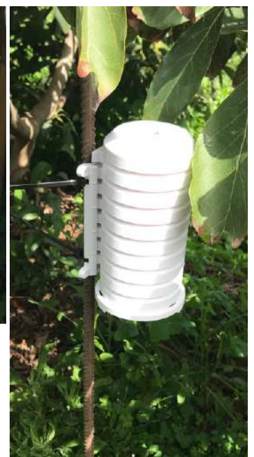
Figura 10 y 11: Registrador de temperatura y humedad y carcasa protectora
