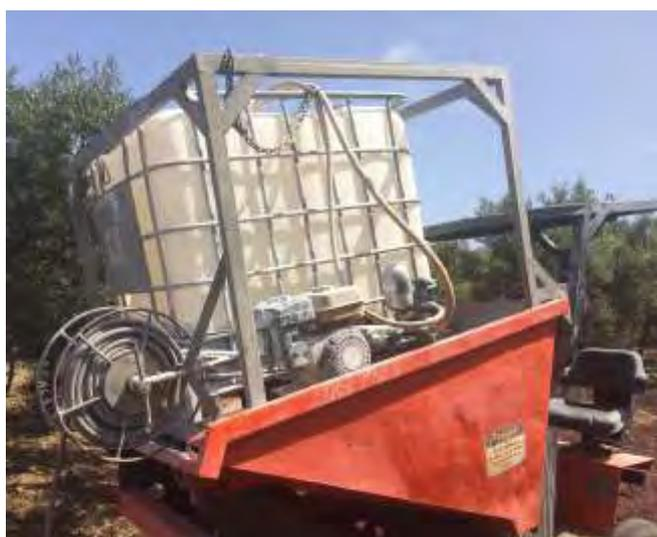
Foto 3: Tanque de caldo y bomba
