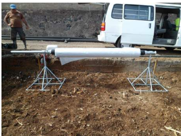
Foto 3.- Soporte para desenrollar el plástico en campo.
