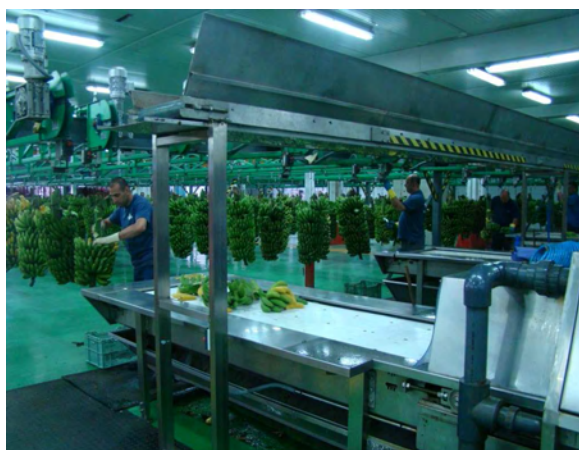
Foto 2.- Fruta en cable carril y desmanillado.
