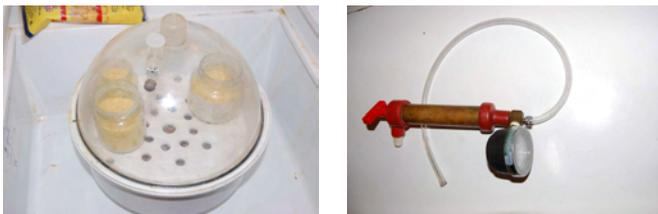
Foto 2. Campana de vacío y bomba de succión.
