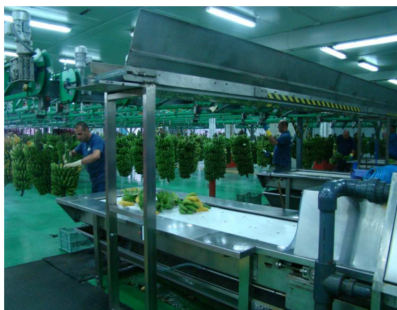
Foto 3.- Fruta en cable carril y desmanillado.
