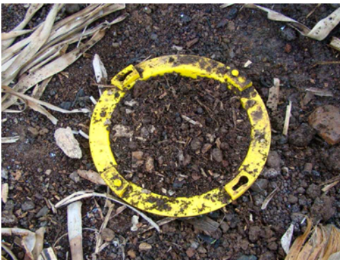
Foto 10.- Capa de tierra colocada sobre el disco plástico.
