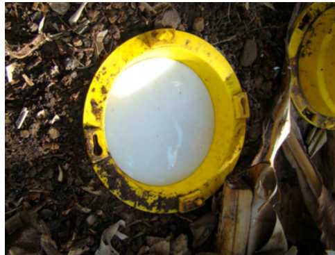
Foto 9.- Disco plástico colocado sobre reborde existente en la parte inferior de la trampa.
