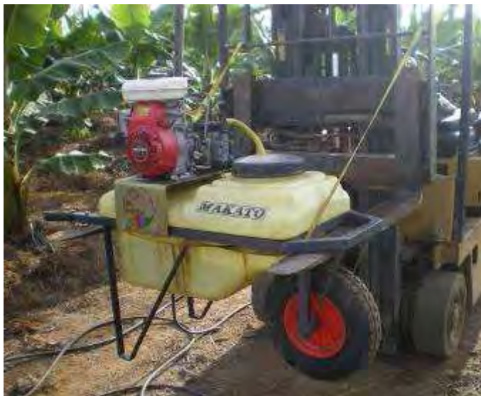
Foto 3. Pulverizador hidráulico a motor empleado en la aplicación de los tratamientos.
