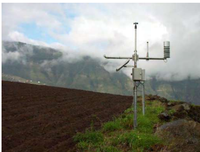
Figura 9: Estación agrometeorológica en cultivo sembrado de papa.
