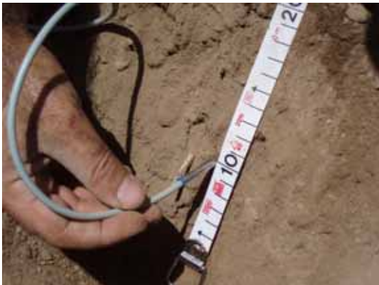
Foto 7.- Colocación del sensor de temperatura a 10 cm de profundidad.
