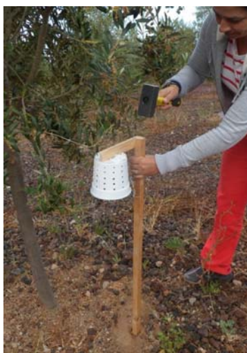
Foto 1.- Colocación del sensor de temperatura y humedad.
