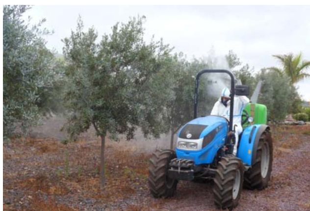
Foto 3 y 4.- Aplicación del caolín mediante pulverizador hidroneumático (atomizador) suspendido al tractor.
