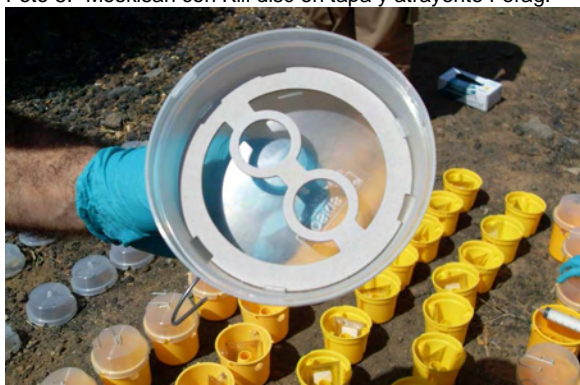
Foto 10.- Detalle del Kill disc acoplado a la tapa.
