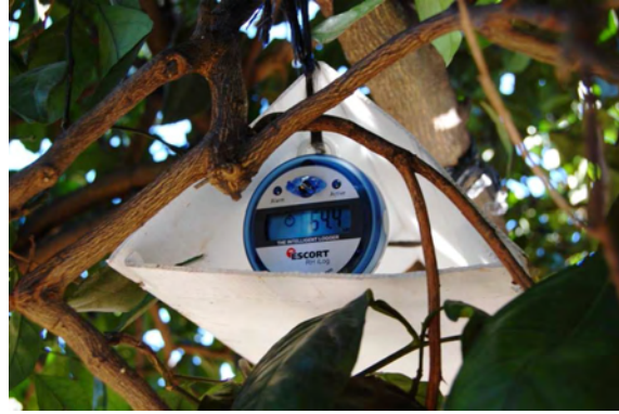
Foto 2.- Registrador de temperatura y humedad.
