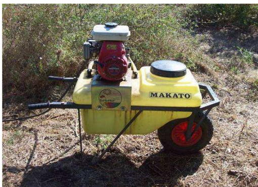
Foto 4.- Pulverizador hidráulico a motor empleado en la aplicación de los tratamientos.
