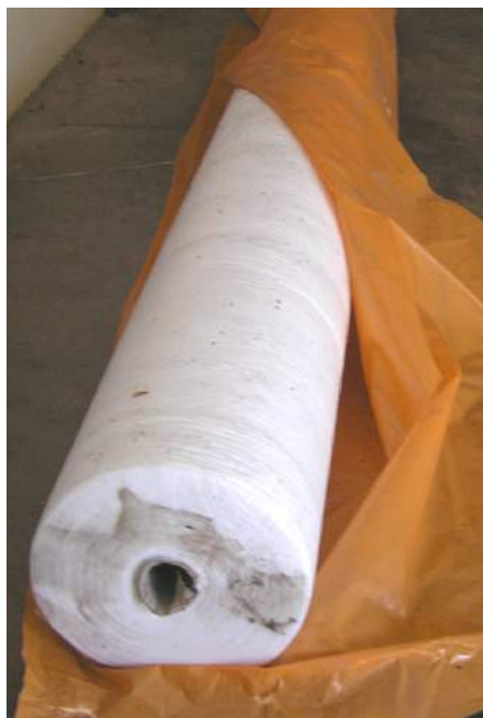
Foto 2.- Rollo de manta térmica de 1.000 m.l., de 17 gramos de grosor y ancho de 3,20 m.
