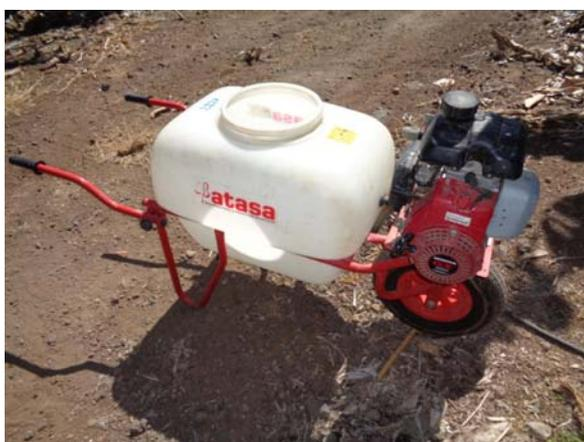
Foto 8.- Pulverizador hidráulico de carretilla.
