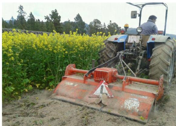
Foto 17.- Pase de la fresadora para la incorporación de la mostaza.
